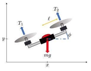
$$\begin{bmatrix} \dot{x} \\ \dot{v}_x \\ \dot{y} \\ \dot{v}_y \\ \dot{\phi} \\ \dot{\omega} \end{bmatrix} = \begin{bmatrix} v_x \\ \frac{-(T_1 + T_2)\sin\phi}{m} \\ v_y \\ \frac{(T_1 + T_2)\cos\phi}{m} - g \\ \omega \\ \frac{(T_2 - T_1)\ell}{I_{zz}} \end{bmatrix}$$
